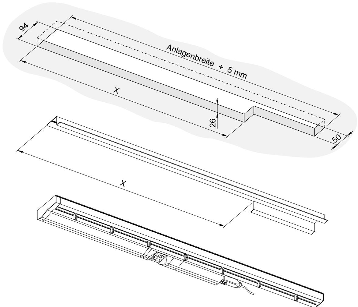
Decken- und Schienenausschnitt „X“
