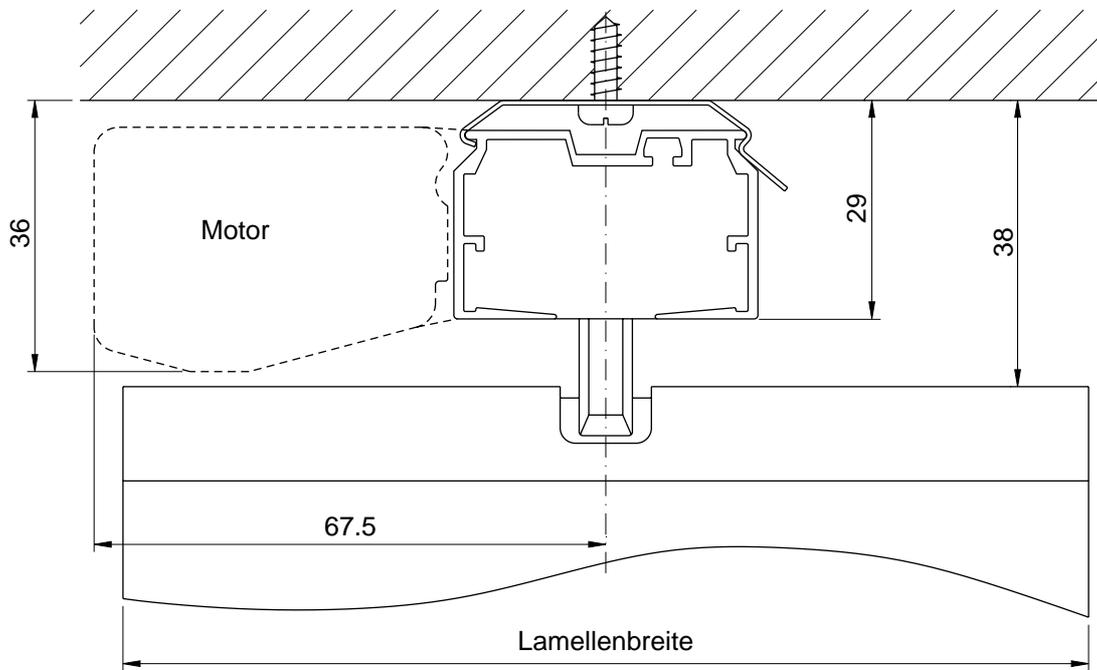
Einbauprofil zum Einputzen (mit seitlichem Motor)
