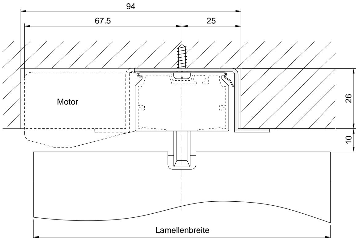
Maßangaben zum Deckenausschnitt u. Schienenausschnitt
